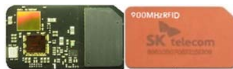
図6 USIMカード（アンテナ内蔵型）
